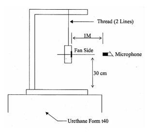
1 METER FROM MICROPHONE TO FAN INTAKE
