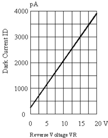
Fig.1 DARK CURRENT VS. REVERSE VOLTAGE
