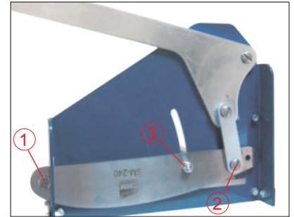
Zur **Demontage des Obermessers** entfernen Sie zu erst die Schutzscheibe aus Plexiglas. Diese verfügt über drei Stege, die in entsprechende Langlöcher in der Montageplatte eingerastet sind. Durch leichtes Verformen der Abdeckscheibe kann diese abgenommen werden.
