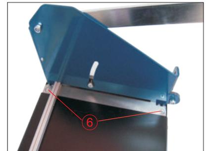
Bei **Montage des Obermessers** müssen Sie darauf achten, dass sich zwischen Messer und Montageblech keine Späne oder größere Schmutzpartikel befinden. Sichern Sie die Schrauben mit einem Schraubensicherungslack (z. B. Loctite 2620).
