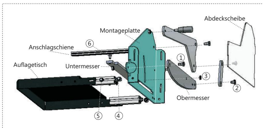
Obermesser (Stahl, gehärtet HRC 62)
