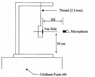
1 METER FROM MICROPHONE TO FAN INTAKE
