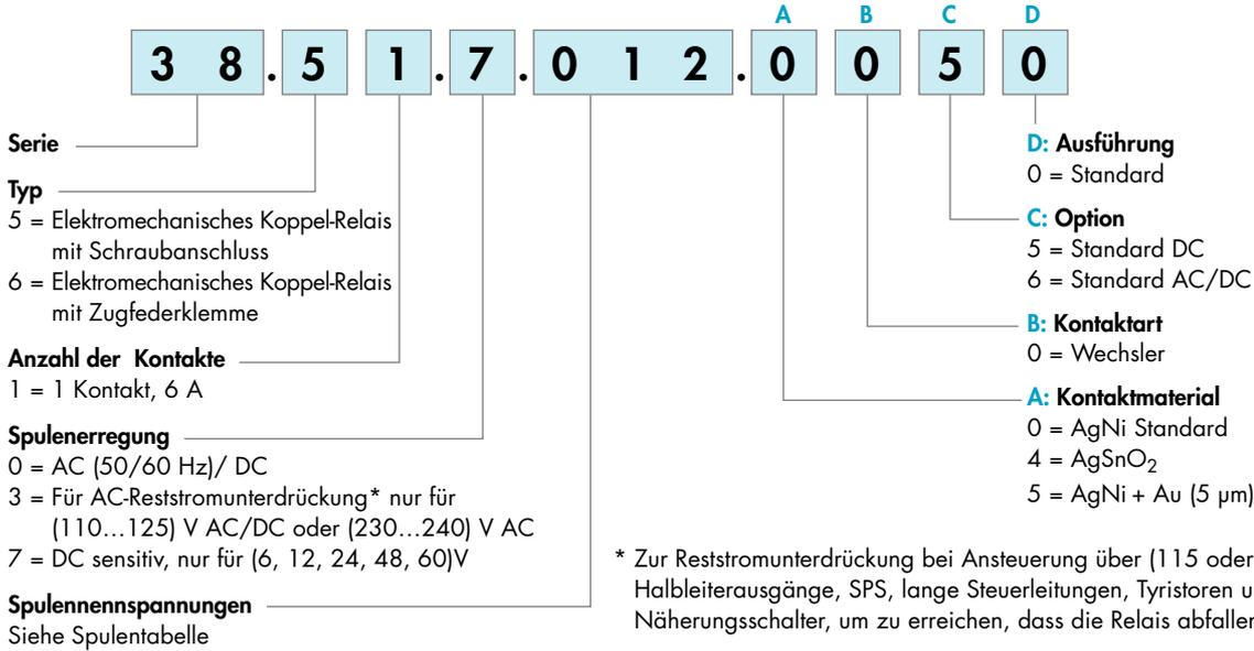
\* Zur Reststromunterdrückung bei Ansteuerung über (115 oder 230) VAC, Halbleiterausgänge, SPS, lange Steuerleitungen, Thyristoren und induktive Näherungsschalter, um zu erreichen, dass die Relais abfallen.
