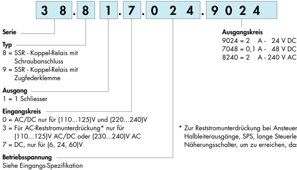
\* Zur Reststromunterdrückung bei Ansteuerung über (115 oder 230) V AC, Halbleiterausgänge, SPS, lange Steuerleitungen, Thyristoren und induktive Näherungsschalter, um zu erreichen, dass die Relais abfallen.
