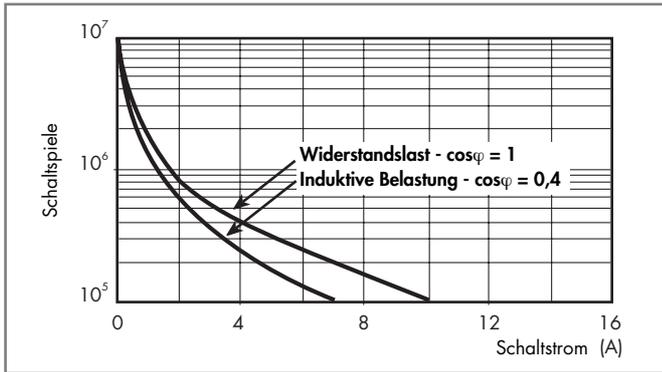
**H 36 - Gleichstromschaltvermögen bei DC1 - Belastung**
