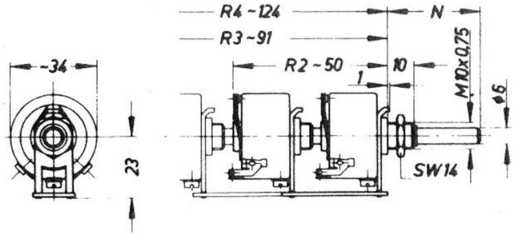
Die Befestigung der kompletten Anordnung erfolgt wie bei der Normalausführung durch Einlochmontage. Die Drehwiderstände sind elektrisch vollkommen getrennt, die Schleifer sind isoliert auf gemeinsamer Achse angeordnet. Drehwiderstand I beim Drehknopf. Alle weiteren Einzelheiten siehe Normalausführung.
