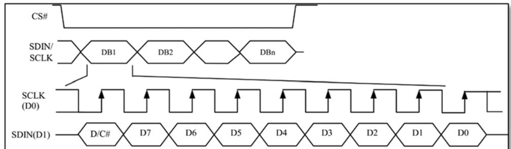
Eine Busy-Abfrage ist nicht notwendig. Die Taktrate kann bis zu 10 MHz betragen. Die Datenübertragung erfolgt im SPI Mode 3, MSB first (9 Bit).
