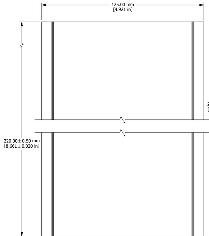
EXTRUSION DESIGNED FOR 120MM WIDE PC BOARD
