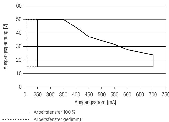
Es ist sicherzustellen, dass der LED-Treiber ausschließlich innerhalb des gezeigten Arbeitsfensters betrieben wird. Besondere Aufmerksamkeit ist dem gedimmten Betrieb sowie dem DC- und Notlichtbetrieb zu widmen, da aufgrund der verwendeten Amplituden-Dimmung die Modulusspannung mit dem Dimm-Level variiert. Eine Unterschreitung der spezifizierten minimalen Ausgangsspannung des LED-Treibers kann zur Abschaltung führen. Siehe Abschnitt „6.11 Lichtlevel im DC-Betrieb“ für mehr Informationen.
